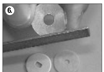
6. Vegyük jobban szemügyre a fém alátétek peremeit. Ha kell, a „jelentéktelen” sorjájukat távolítsuk el. A fék ezután olyan lesz, mintha kicserélték volna!
